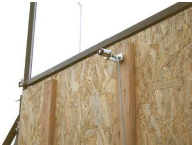
Obr. 9: Pyranometr 2 k měření záření za pokusnými deskami
