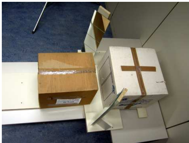
Obr. 2: V laboratoři byla vhodnost zrcadel testována ve zjednodušených zkouškách a zjišťován příznivý průběh paprsků.
