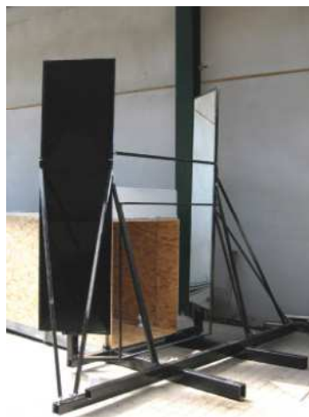
Obr. 3: Od modelu k uskutečnění: zde zrcadla (0,65m x 2,50m) na skoro hotovém zkušebním tunelu ve výrobní hale.
