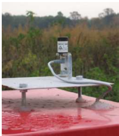
Obr. 8: Pyranometr 1 k měření globálního záření
