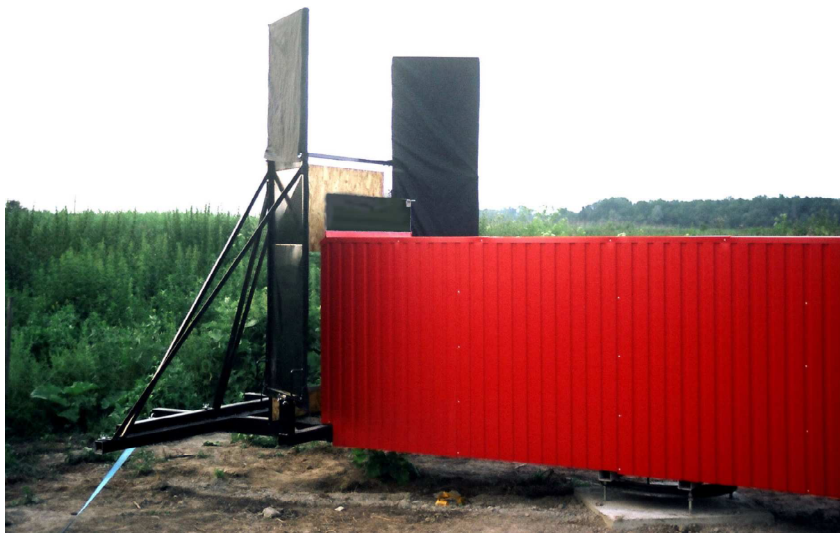
Obr. 1: Nový zkušební tunel („poletový tunel II“) v Hohenau-Ringelsdorfu má umožnit pokračování ve výzkumech z let 2004 a 2005 při rozšířených možnostech zařízení a umožnit tak vytvářet lepší prognózy týkající se účinnosti varovných značení směřujících k redukci nárazů ptáků do skleněných ploch. Letový tunel II na obr. mimo provoz, zrcadlo zakryta.
